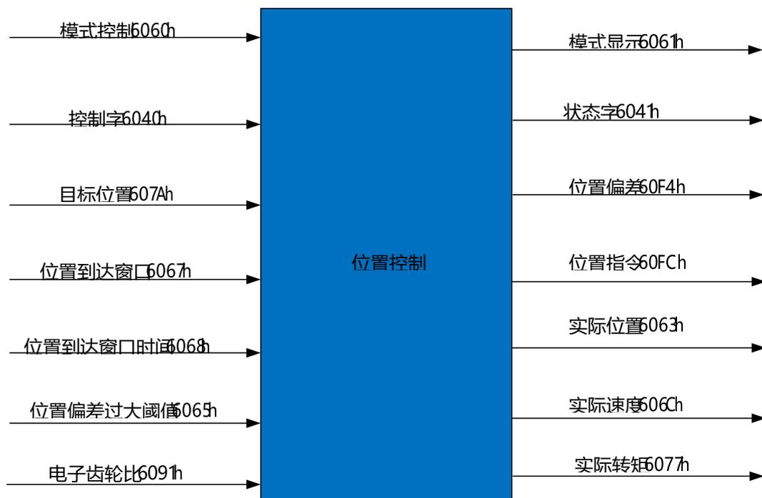
图 6.5 周期同步位置模式输入输出框图关联索引码：
