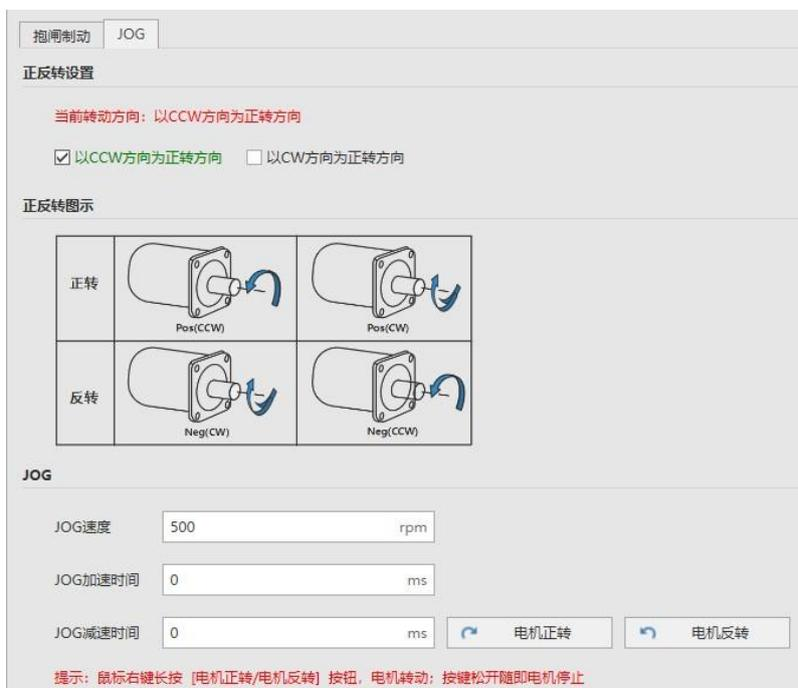
图 5.5 电机方向设置
