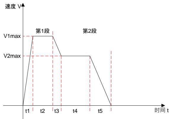
V1max、V2max: 第1段、第2段指令速度;
