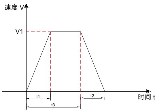
如上图所示，该段速度指令为  $V_1$ ，实际加速时间  $t_1$  为：
