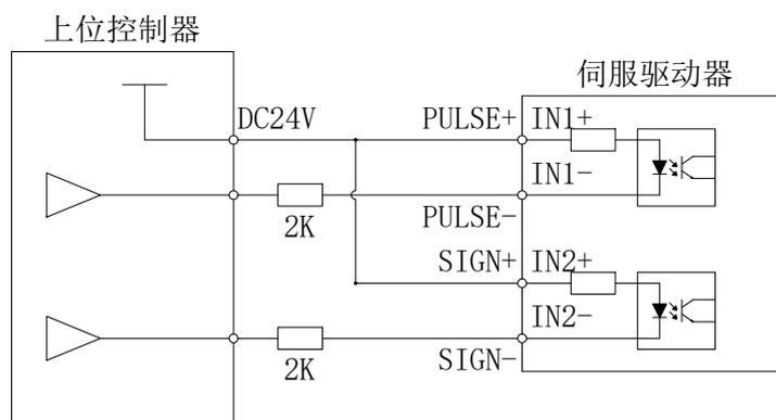
(3) 普通 IO 控制：使用单端接法，外接通用输入信号，如点动正/反转信号：
