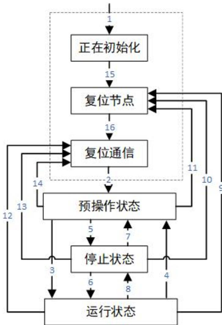
上图中除(1)、(15)、(16)的转换外，其余均由 NMT 报文实现，且只有 NMT 主机能够发送 NMT 控制报文，报文数据格式如下所示：
