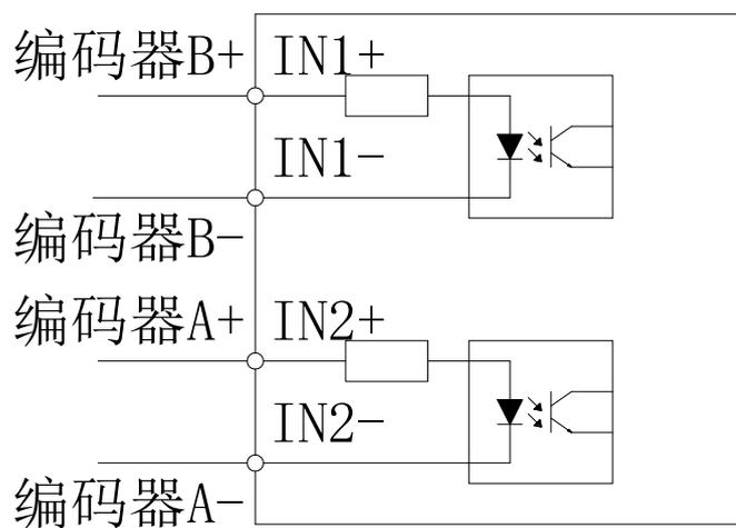
(2) 脉冲控制：外接脉冲+方向差分信号
