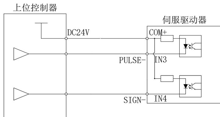
◆ 条件允许情况下，请优先使用 IN1、IN2 作为脉冲+方向信号的输入端子
