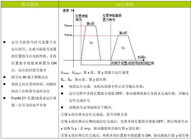
多段位置运行方式设置为 IN 切换运行时,请将驱动器的 4 个(可根据实际运行总段数,设定需要的 IN 端子个数)IN 端子配置为功能  $14\sim17$ (Fun IN.  $14\sim$ Fun IN. 17: 位置/速度表切换),并确定 IN 端子有效逻辑。
