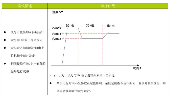
多段速度运行方式设置为 IN 端口切换运行时,必须将伺服驱动器的 4 个 IN 端子配置为功能  $14\sim17$ (Fun IN.  $14\sim$ Fun IN. 17: 多段运行指令切换),并确定 IN 端子的有效逻辑。同时可将伺服驱动器的 1 个 IN 端子配置为功能 19(Fun IN. 19: 速度指令方向设定),切换速度指令方向。
