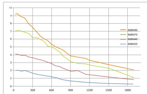
驱动器: 3R110PLUS V3.0 电压: 220VAC 电流: 额定 细分: 2000
