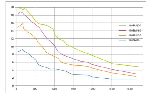
驱动器: 3R110PLUS 电压: 220VAC 电流: 额定 细分: 2000
