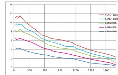
驱动器: T86 电压: 60VAC 电流: 额定 细分: 1600
