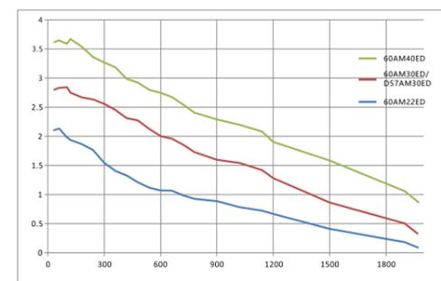
驱动器: T60 电压: 48VDC 电流: 额定 细分: 1600
